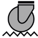
Überlastung durch unebene Böden
