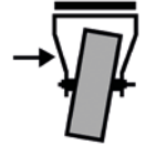
Überlastung durch Querkraft
