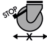
Überlastung durch Bewegungen im festgestellten Zustand
